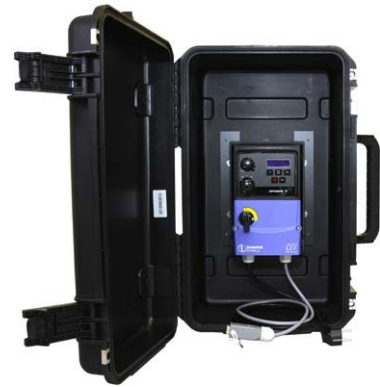
Abb. 7 Vertikaler Einbau des Konverters
