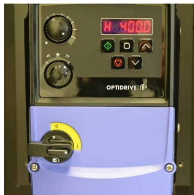
Abb. 8e Schalter 3 auf max. 400 Hz eingestellt
