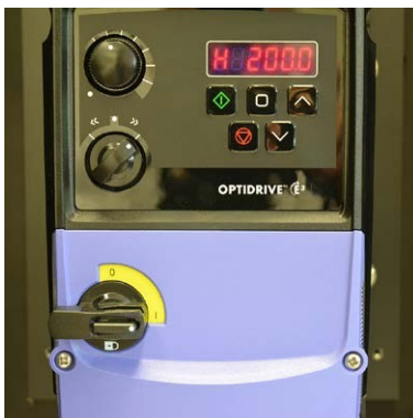
Abb. 8d Schalter 3 auf 200 Hz eingestellt
