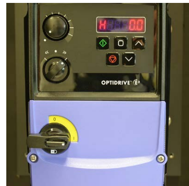
Abb. 8c Schalter 2 in Stellung >> vorwärts
