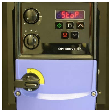
Abb. 8b Schalter 1 in Stellung ON
